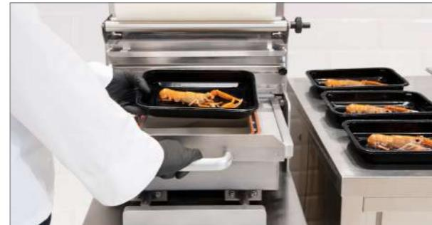
**Design compatto** L'UNICA 20 è particolarmente indicata per un uso efficiente dello spazio. Con una larghezza di 450 mm, il design compatto di questa termosigillatrice con funzione ATM è elegante e adattabile a ogni situazione.
