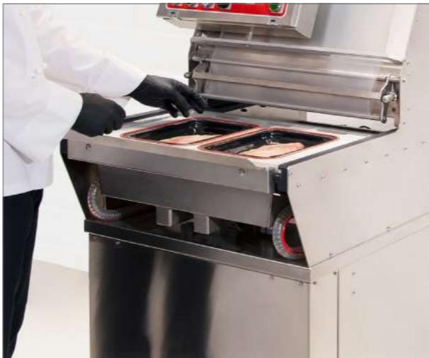
**Confezionare in ATM** Confezionare in ATM (atmosfera modificata) significa mantenere le caratteristiche proprie dell'alimento fresco confezionato il più a lungo possibile, senza utilizzare conservanti chimici. Il principio su cui essa si basa prevede la sostituzione dell'aria presente nell'involucro con una miscela prestabilita di gas. In questo modo la qualità del cibo è tutelata e la shelf life è prolungata. Perfetta per pasta fresca, prodotti precotti o crudi (pesce e carne).
