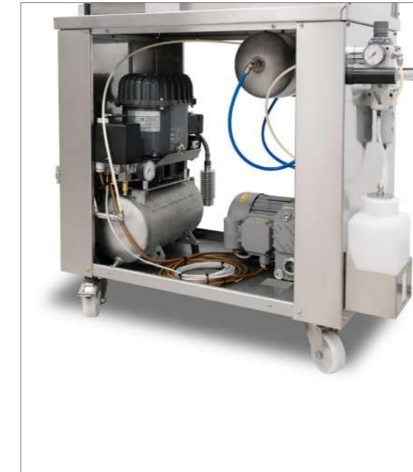
**Compressore d'aria integrato 6 L** da integrare nel supporto a mobile con serbatoio d'accumulo
