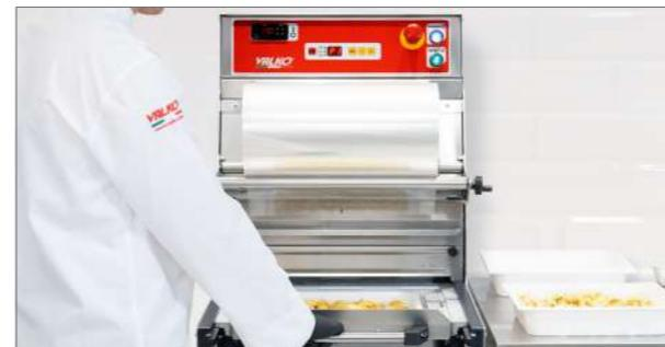
**Massima flessibilità** Le termosigillatrici manuali puntano sulla flessibilità e sulla velocità. Grazie al sistema di cambio stampo rapido, infatti, l'operatore può, senza l'utilizzo di avvitatori, sostituire comodamente lo stampo e la piastra saldante. Il tutto in totale sicurezza e nel più breve tempo possibile. Infine, gli stessi stampi potranno essere riutilizzati, in un secondo momento, con le termosigillatrici semiautomatiche della serie TVG.
